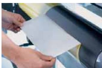
13. kép. Ragasztószalag eltávolítása
