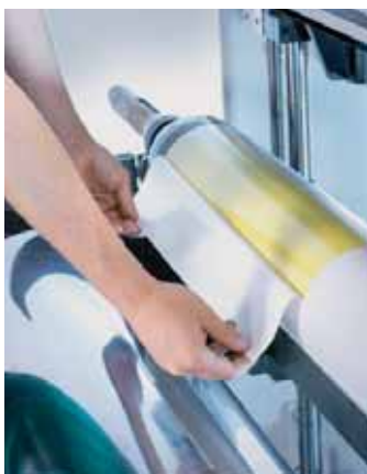
5. kép. Védőréteg eltávolítása
