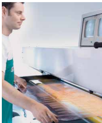
7. kép. Klisé illesztése
