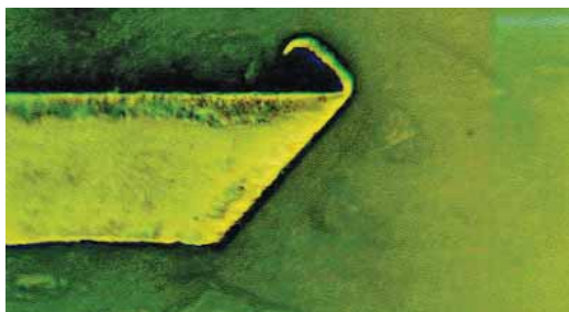
Fémforgács a lamella végén; sérült felületű raszterhenger (scoring line)
