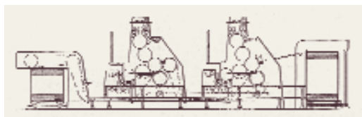
Kétcilinderes íves ofszetnyomó gép Caspar Hermann szabadalma alapján
