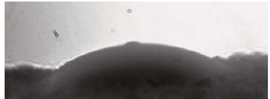
4/b ábra. Ülő dijód-metán csepp a LubroTec felületen
