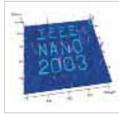
3. ábra. Nanolithográfival készült, 0,5 mikron méretű, nanografika. Ma még csak biztonságttechnikai és kísérleti célra használják
