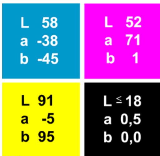
1. ábra. A szabványos négyszínnyomó flexófestékek CIELAB L^* , a^* , b^* színíngerjellemezői az ISO 2846-5 szerint
