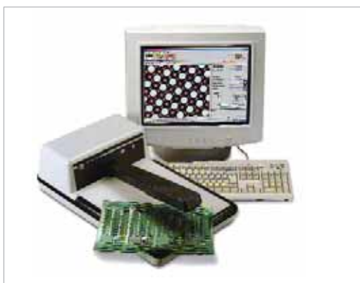
3. ábra. Gretag-Macbeth gyártmányú Vipflex 334 + Flexo Eye szoftver és képelemző rendszer, a filmek, magas- és flexónyomóformák, nyomatok transzmissziós/reflexiós vizsgálatára
