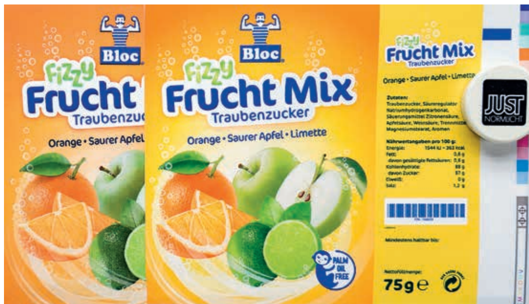
A kép bal szélén ugyanannak a PEZ szőlőcukor csomagolásnak a standard, CMYK+Pantone színes, oldószeres festékű változata, a jobb oldalán a hétszínnyomásos REVO UV-nyomata látható
