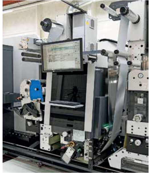
A Steinemann DPE Digital Embellishment Unit-ja (DEU), beépítve egy Gallus Labelfire 340-be (Forrás: Gallus Ferd. Rüsch AG)
