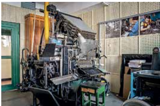
Sorszedőgép, más néven linószedőgép a legegyszerűbb és legtermékenyebb szöveg-előállítás biztosította, szovjet, leningrádi 1960-as évekbeli gyártmányú
