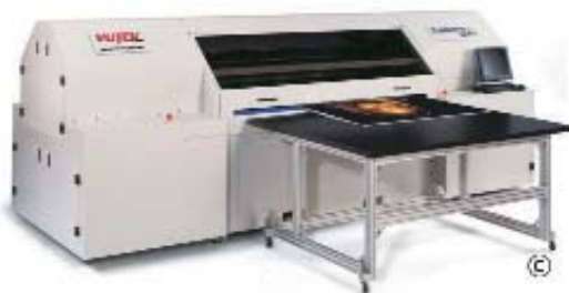
12. ábra. VUTEK UltraVU oldószermentes, digitális, síkágyas inkjet nyomtató
