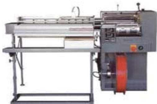
16. ábra. Marlon 2002 márkájú műanyagspirál gyártó gép a PVC Spiral Supply cégtől
