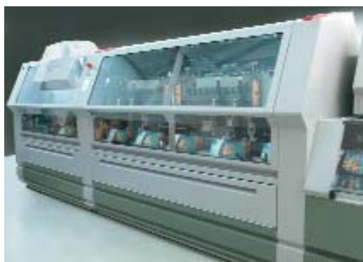
11/a ábra. Müller Martini Supra, nagy teljesítményű irkafűzősor
