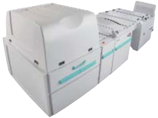
8/a ábra. Fuji Luxel V9600/Vx 9600 CTP. Automata, lilalézeres (43 B1 lemez/h)
