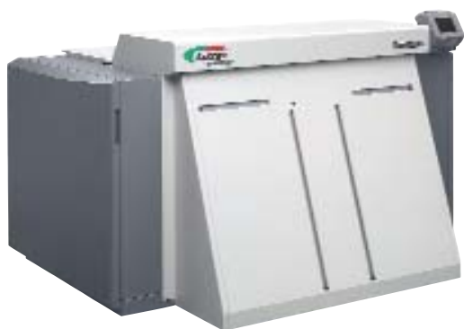
8/d ábra. Fuji Luxel Vx-9600, kézi, lilalézeres. (43 B1 lemez/h)
