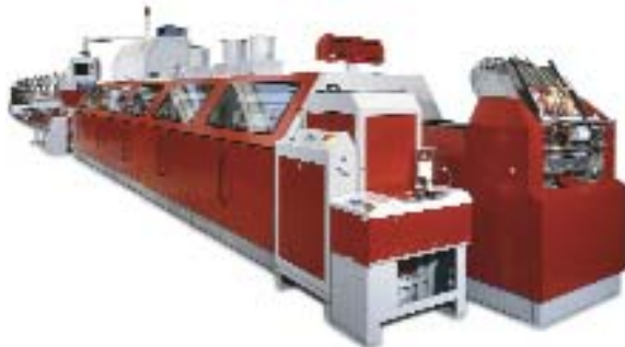
11/b ábra. Müller Martini Bolero univerzális ragasztóköti gép
