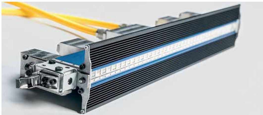
A rögzítő modul közepén lévő részből kijutó UV-fény rögzíti a tintacseppeket (Forrás: Gallus Ferd. Ruesch AG)
