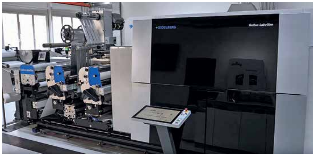
A Labelfire akár egy ígásló. Gallus Labelfire két flexó nyomtatóegységgel az UV tintasugaras digitális nyomtatóegység előtt, hét színnel és fehérrel (Forrás: Gallus Ferd. Rüsch AG)
