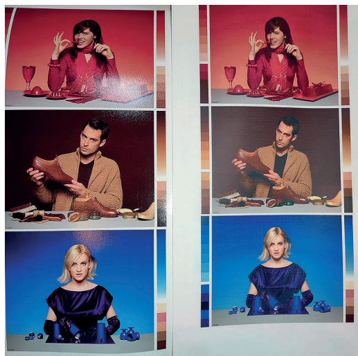
4. ábra. Jobb oldalon látható a cukorlapra nyomtatott teszt, összehasonlítva a Fogra39 módosított papírférrrel készített prooffal
