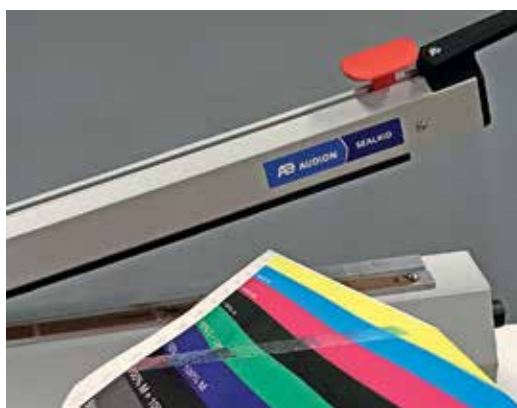
A TITON száraz festékekkel ellentétben a hagyományos száraz festékrétegek nem rendelkeznek kellő hővel szembeni ellenállással a hajlékony csomagoláshoz való használatra. (Forrás: pack.consult)
