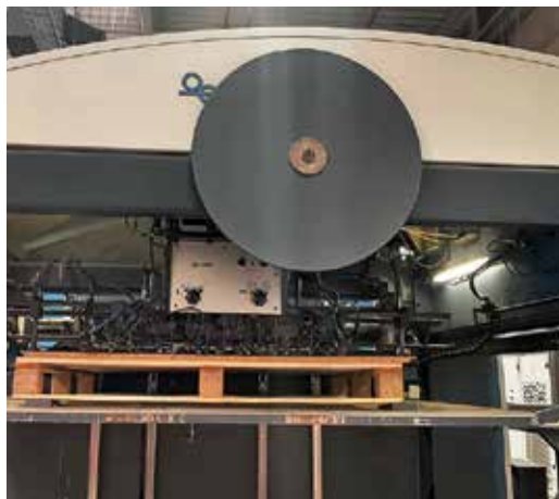
A 220 cm magasan felfogatott, eredetileg 20 cm átmérőjű állítókeréket 58 cm átmérőjűre cseréltük. Azóta az alacsonyabb gépkezelők is könnyen tudják kezelni.
