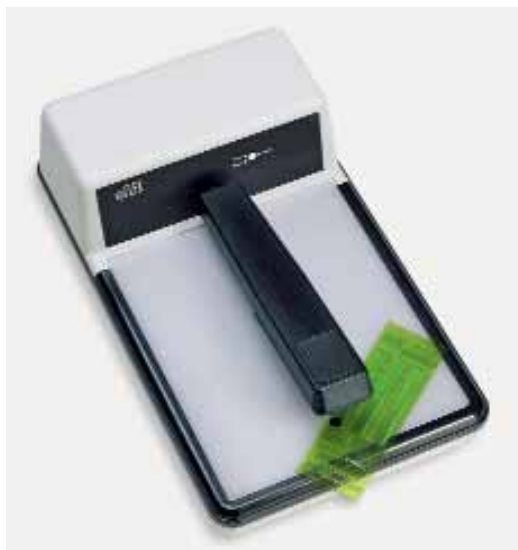
4. ábra. VipFlex flexó nyomólemez-ellenőrző rendszer
