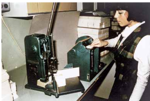
Minikönyv gerincgömbölyítése a Rácz Ferenc által tervezett gömbölyítőgéppel
